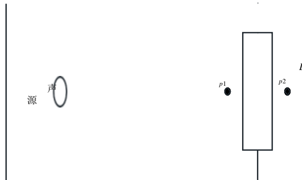
图 5.2-5 室内声源等效为室外声源图例
